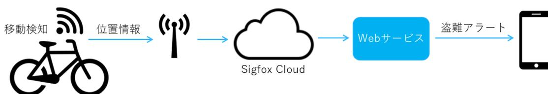
自転車に搭載したデバイスと所有者のスマートフォンを連携させ、所有者が自転車から離れた後で自転車の移動を検知した場合、デバイスの位置情報を Sigfox の通信を利用してクラウドに送信します。
